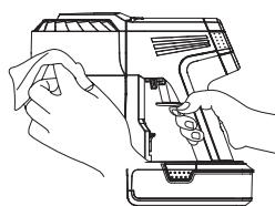
Nettoyez avec un chiffon humide, en prenant soin d'empêcher l'eau de pénétrer dans le corps principal et la batterie de l'appareil.
